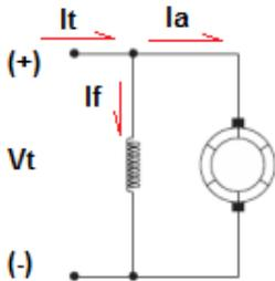
*A corrente “ $I_t$ ” é dada pela razão entre a potência elétrica de entrada do motor ( $P_e$ ) e a tensão da fonte ( $V$ ), logo:*
