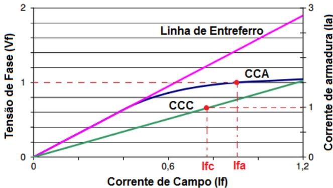
A linha de entreferro representa a região com resposta **linear** da máquina síncrona ao longo de sua curva característica a vazio (CCA), da qual se obtém a indutância síncrona não saturada da máquina.
