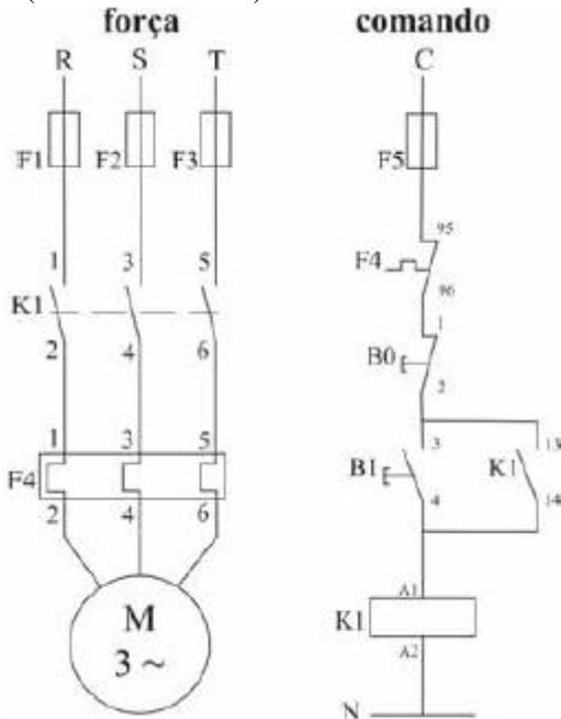
A figura apresentada representa um diagrama de comando para um motor trifásico. O tipo de acionamento correspondente ao esquema e partida
